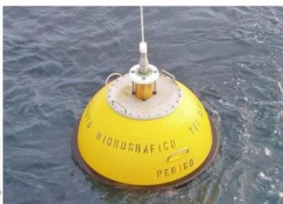
Boia ondógrafo direcional de Sines, transmite os dados a cada 10 minutos
