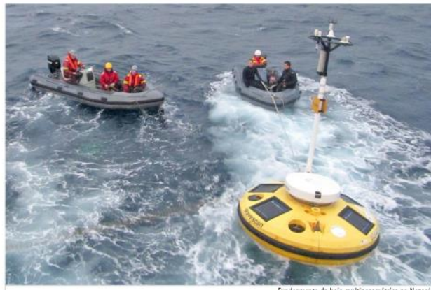
Fundejamento da boia multiparamétrica na Nazaré
