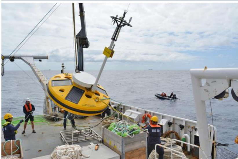
Fundejamento da boia multiparamétrica em Sines
