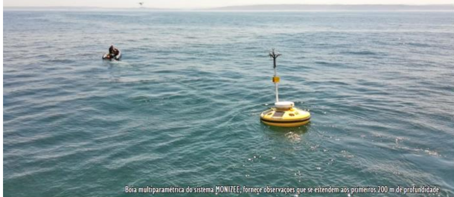
Boia multiparamétrica do sistema MONIZEE, fornece observações que se estendem aos primeiros 200 m de profundidade
