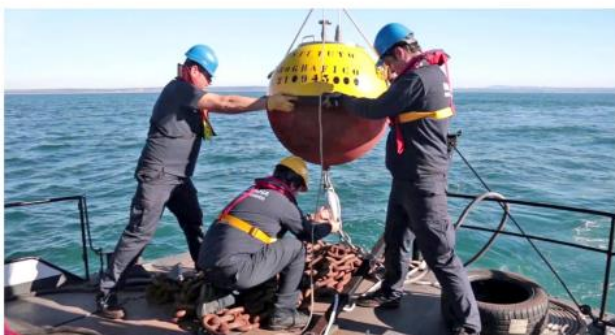
Boias ondógrafo direcionais, constituída por 3 boias instaladas na plataforma continental média ao largo de Leixões, Sines e Faro
