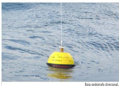
Boia ondógrafo direcional, mede os parâmetros da agitação marítima ao largo da plataforma continental
