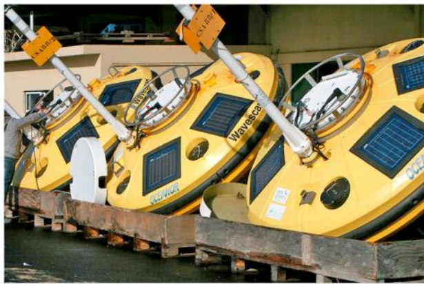
Boias multiparamétricas a serem preparadas para o fundeamento
